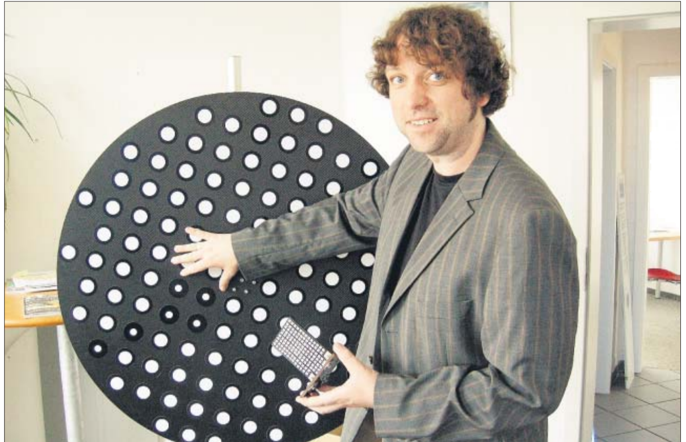
Die Kalibriertafel macht aus der Kamera von Bernd-Michael Wolf ein Messgerät – mithilfe der Tafel wird die Kamera justiert.
